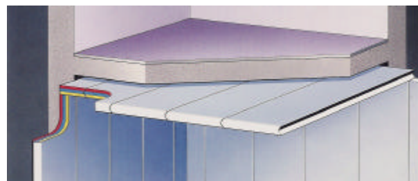
Verstärkung bestehender Massivbau-Tresorräume mit Relastan®-Elementen
